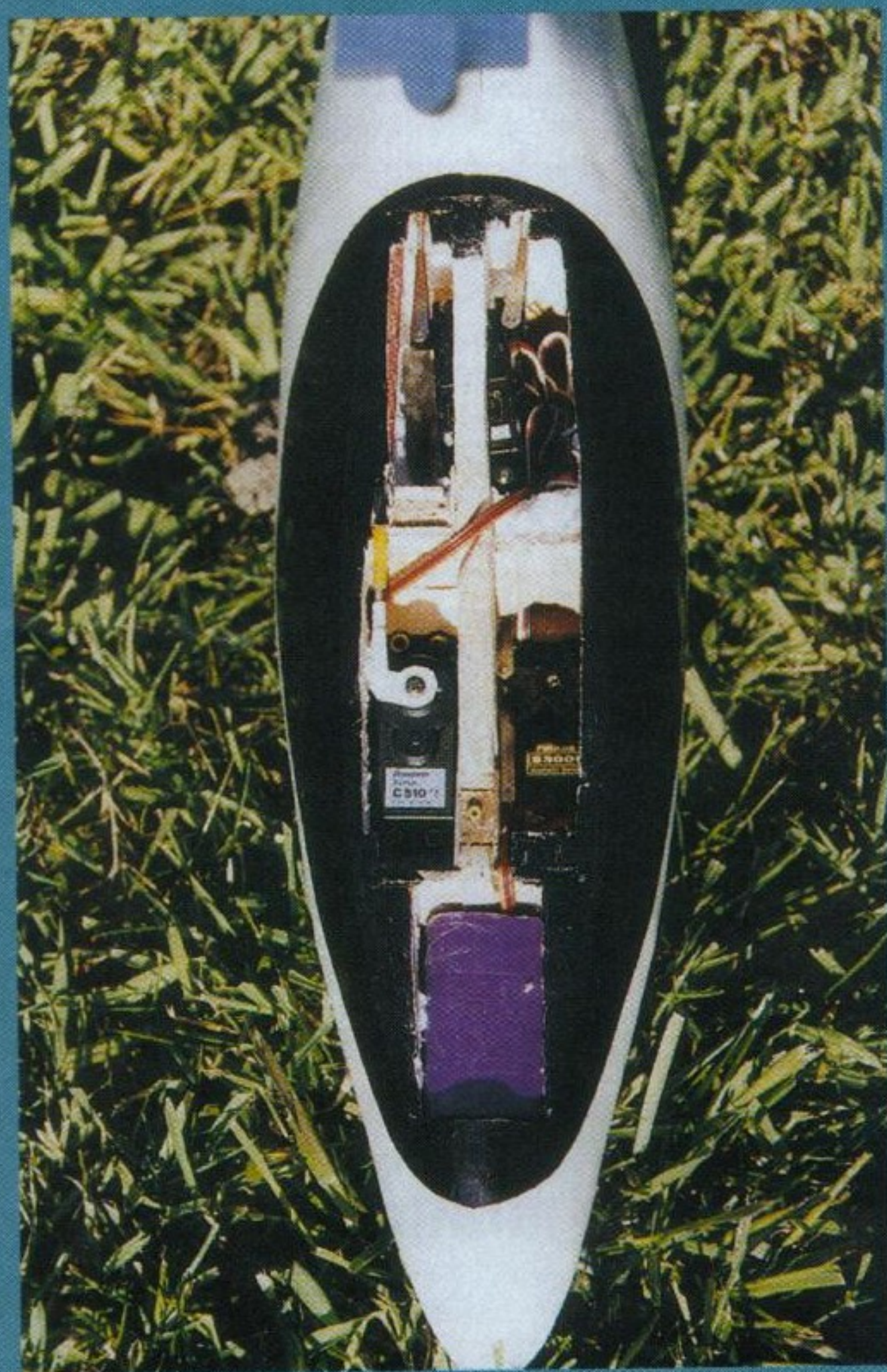
On remarque les tenues latérales, le servo de profondeur, la gaine droite des ailerons et les tubes carbone de l'empennage.
