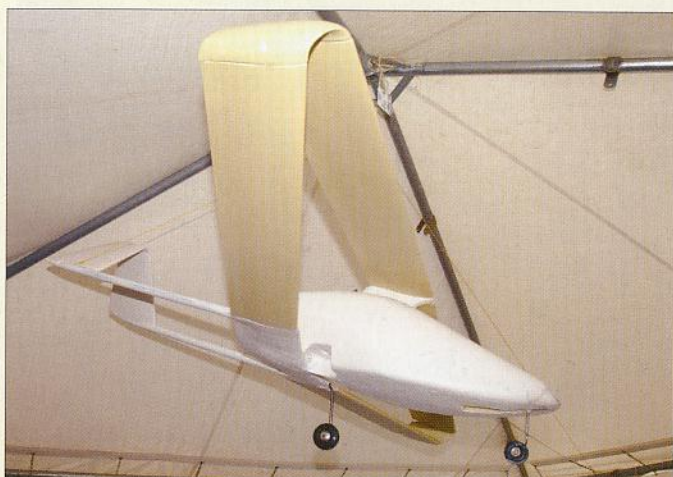
Ci-dessus, un projet innovant pour le milieu de l'ULM, le MN 800 Cocagne. Il s'agit d'un biplace en tandem, bipoutre disposant de deux ailes à grand allongement et jointives. Le prototype de Montagne Noire Aéro vole à 150 km/h avec 48 ch. A côté, le très attendu moteur en étoile Rotec de 100 ch.
