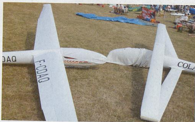
Les deux Edelweiss perso de Jean-Michel Bouquet. A gauche la version "traditionnelle" de 9 m d'envergure pour 45 kg, à droite, la version équipée du système Colab avec une envergure de 6,30 m pour le même poids (voir détails dans l'encadré).
