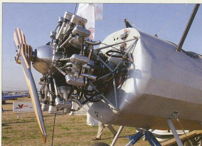
Ci-dessus, un projet innovant pour le milieu de l'ULM, le MN 800 Cocagne. Il s'agit d'un biplace en tandem, bipoutre disposant de deux ailes à grand allongement et jointives. Le prototype de Montagne Noire Aéro vole à 150 km/h avec 48 ch. A côté, le très attendu moteur en étoile Rotec de 100 ch.
